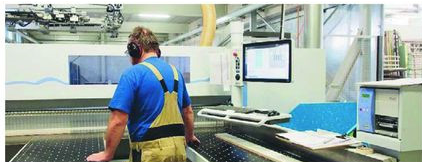
! Der Plattenzuschnitt inklusive Etikettierung erfolgt auf einer Säge-Lager-Kombination von Homag, bestehend aus Flächenlager TLF 211 und Plattenauffeilsäge HPP 300.
