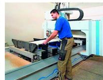
! Auf zwei Bearbeitungszentren von Homag (hier: Venture 240 M) werden die Teile CNC-bearbeitet.
