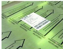
! Die Teile-Etiketten enthalten auch die Barcodes für den Programmaufruf an den beiden CNC-Maschinen.
